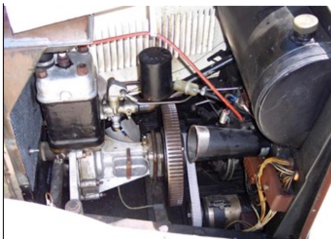
Abb.18: Aero-Motor, 1-Zyl-2-Takt, 499 cm 3
