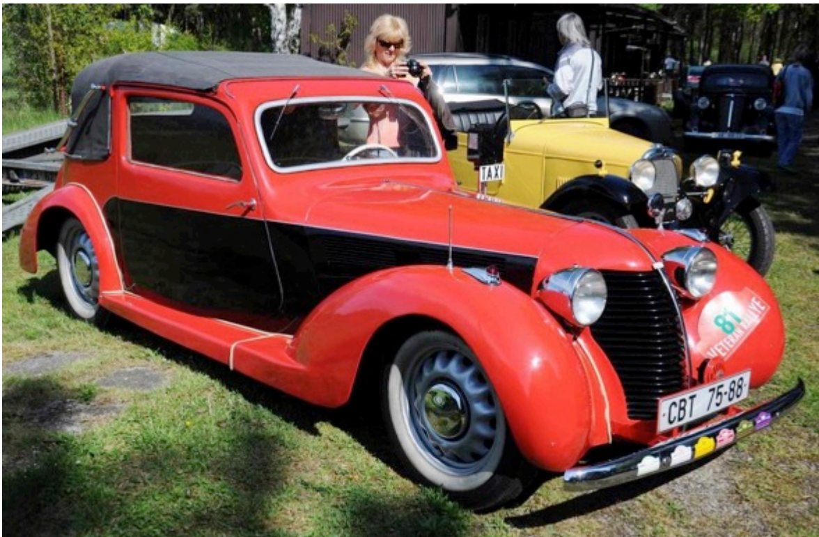
Abb. 36: Für den Modelljahrgang 1939 wurde ein Facelift an der Werkskarosserie vorgenommen. Das Karosseriebauunternehmen Josef Sodomka lieferte den Entwurf dafür. Hier ein Beispiel einer Kabriolimousine.
