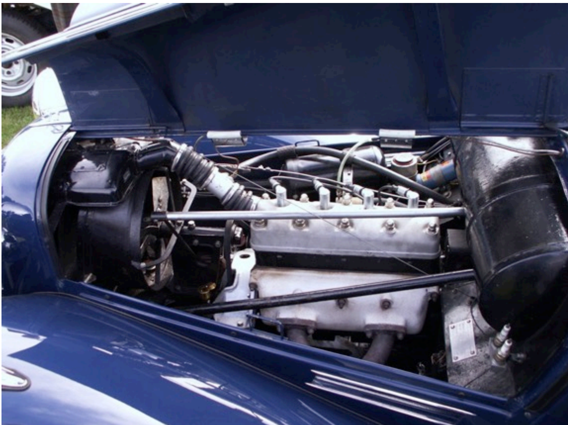
Abb. 37: Aero 50 mit 2000 cm 3 4-Zylinder-Zweitaktmotor mit 50 PS und Vorderradantrieb
