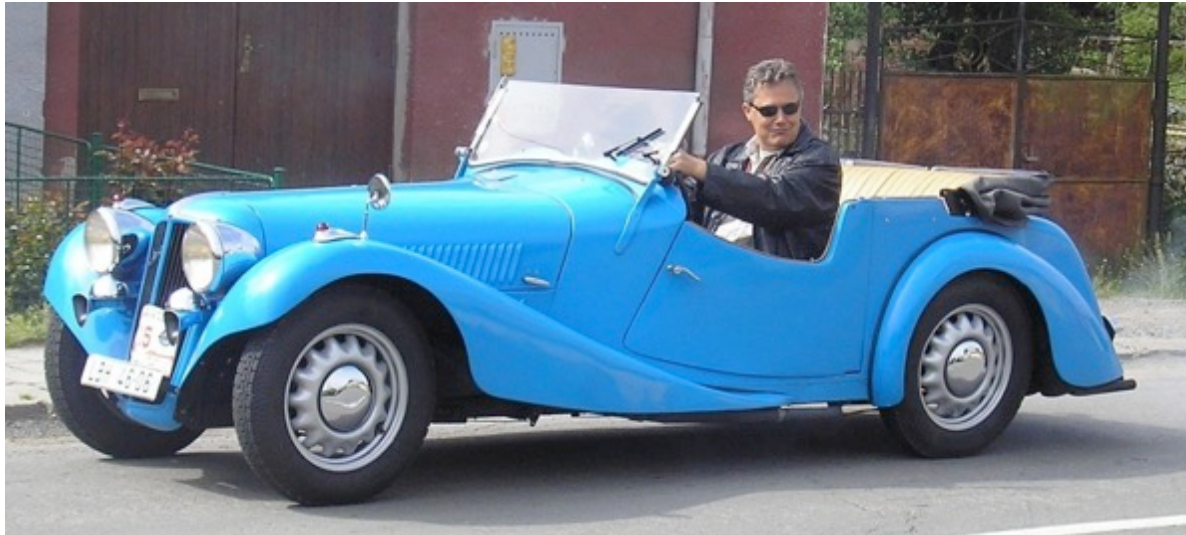
Abb. 33: Aero 30 Sportwagen 4-sitzig / Modell 1933, dessen niedrige Bauweise durch den Plattformrahmen ermöglicht wurde
