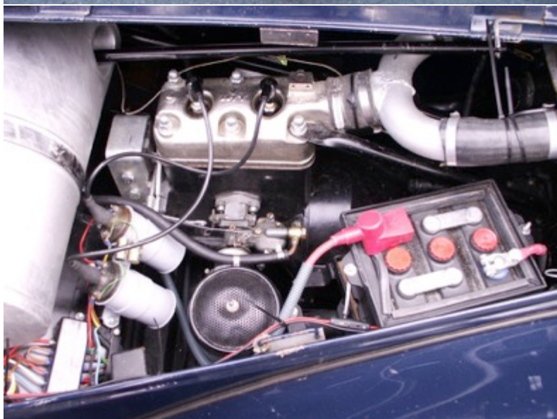
Abb. 34a+b: Aero 30 Roadster, Modell 1936 mit 1000 cm³ 2-Zylinder Zweitakter – Vorderradantrieb
