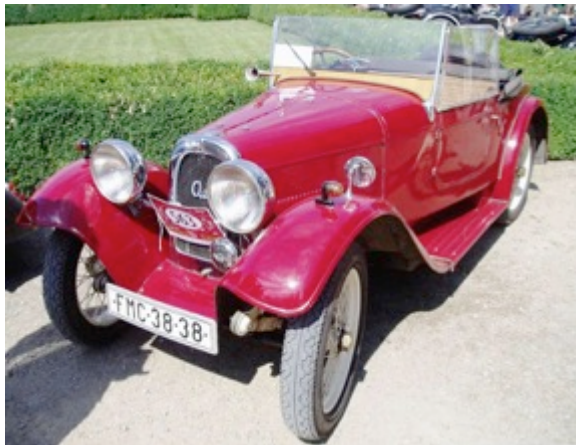
Abb. 23a+b: Aero 10 ab 1929 mit 500 cm³ 1-Zylinder Zweitakter – Hinterradantrieb
