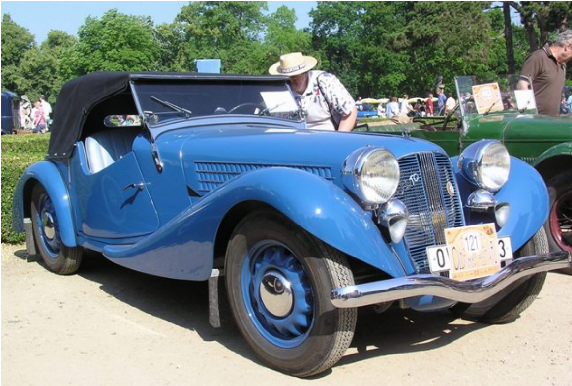
Abb. 37: Aero 50 mit 2000 cm 3 4-Zylinder-Zweitaktmotor mit 50 PS und Vorderradantrieb
