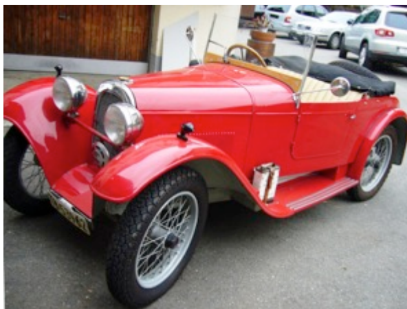
Abb. 24a+b: Aero 18 ab 1931 mit 662 cm³ 2-Zylinder Zweitakter - Hinterradantrieb
