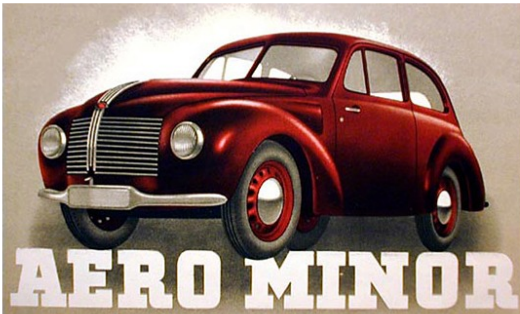
Abb. 64: Der letzte Akt: Die Weiterverwendung des Namens Aero für einen, von JAWA entwickelten Kleinwagen mit 616 ccm 2 Zylinder / 20 PS / 2-Takt Motor und Vorderradantrieb.
