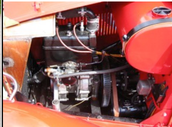
Abb. 25a+b: Aero 1000 ab 1931 mit 1000 cm³ 2-Zylinder Zweitakter – Hinterradantrieb
