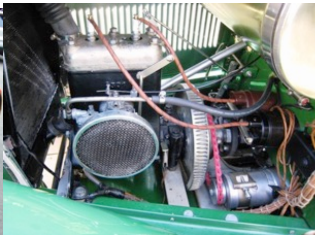
Abb. 24a+b: Aero 18 ab 1931 mit 662 cm³ 2-Zylinder Zweitakter - Hinterradantrieb
