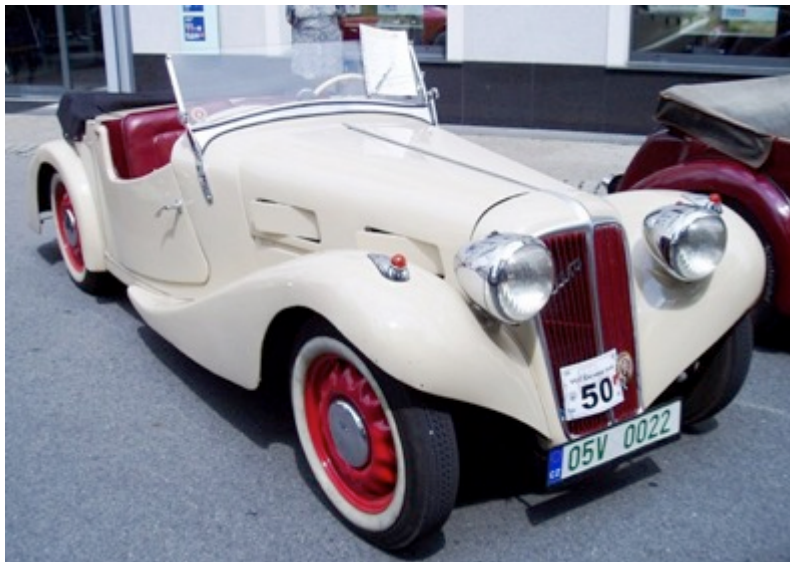
Abb. 33: Aero 30 Sportwagen 4-sitzig / Modell 1933, dessen niedrige Bauweise durch den Plattformrahmen ermöglicht wurde
